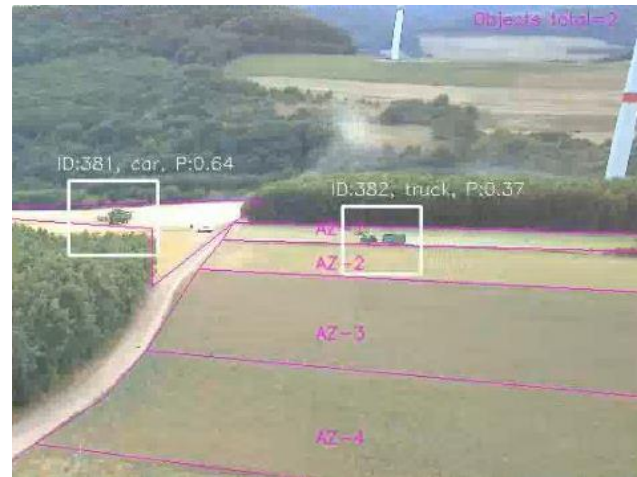
Fig. 9 : Exemple d'un bridage agricole, en Allemagne, réalisé avec l'aide d'un outil de détection automatique (Source : Bioseco).
